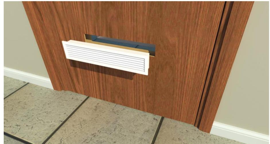
DETALLE 2: DISPOSITIVO DE VENTILACIÓN DE TRASPASO DE AIRE ENTRE RECINTOS
